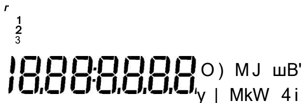
Рисунок 3.1 - Информационные поля ЖК-дисплея теплосчетчика КАРАТ®-Компакт
