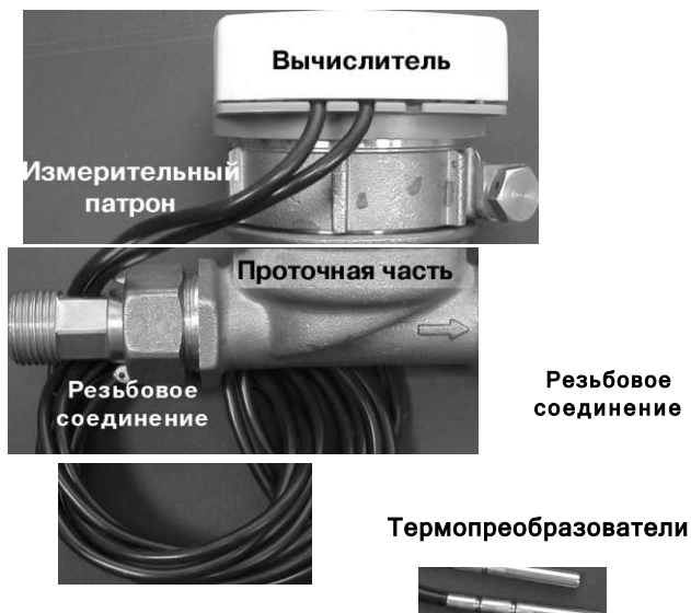
Рисунок 2.1 - Состав теплосчетчика КАРАТ®-Компакт
