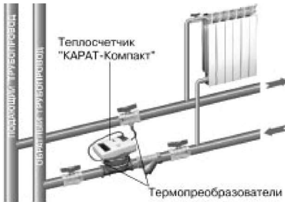
Рисунок 14 — Схема монтажа теплосчетчика «КАРАТ-Компакт» в обратный трубопровод с установкой термопреобразователя в шаровый кран
